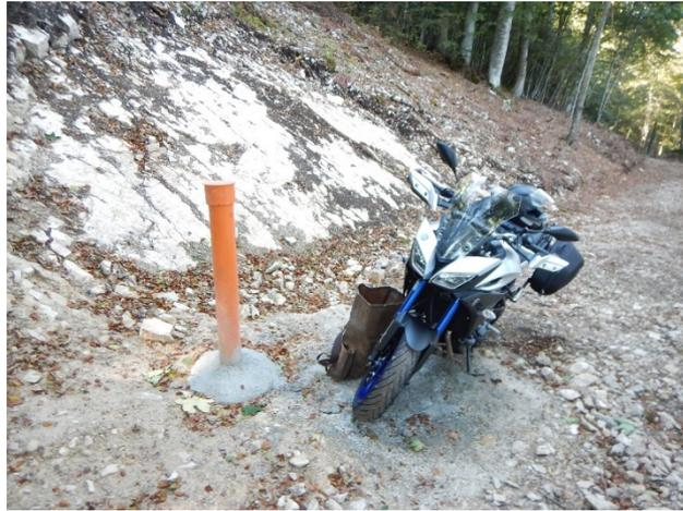
Forage équipé d'un tube piézométrique pour la mesure des niveaux d'eau
